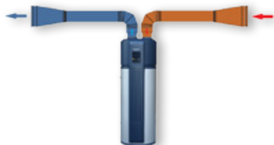
Wariant 3: zasysanie z zewnątrz, wydech do wewnątrz budynku
